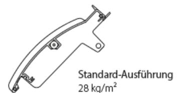
Abb. 1: Querschnitt Lamelle
